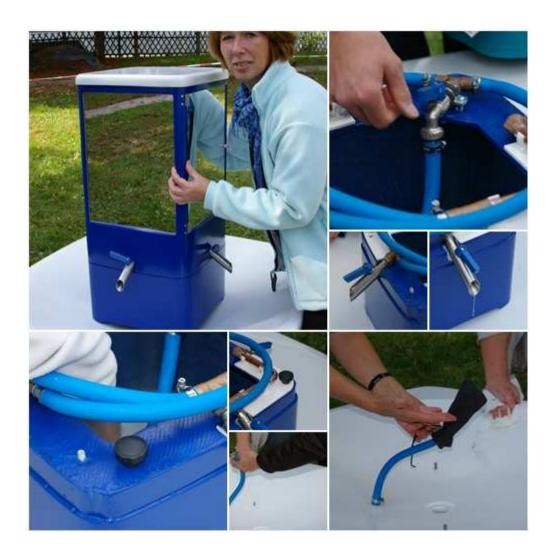
Montageplatten A/B mit Wasserhähnen abnehmen. In Schutzhüllen mit Reißverschluss verpacken
