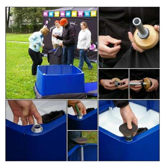
Trinkwasserschlauch (blau, 1/2 Zoll) mit Messingverschraubung am Becken festschrauben.
