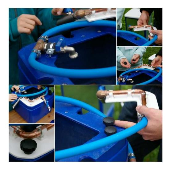
Alle vier Wasserhähne mit blauem Knebel und Haupthahn (HH) durch Linksdrehung schließen (90 Grad Stellung, senkrecht zum Auslauf)
