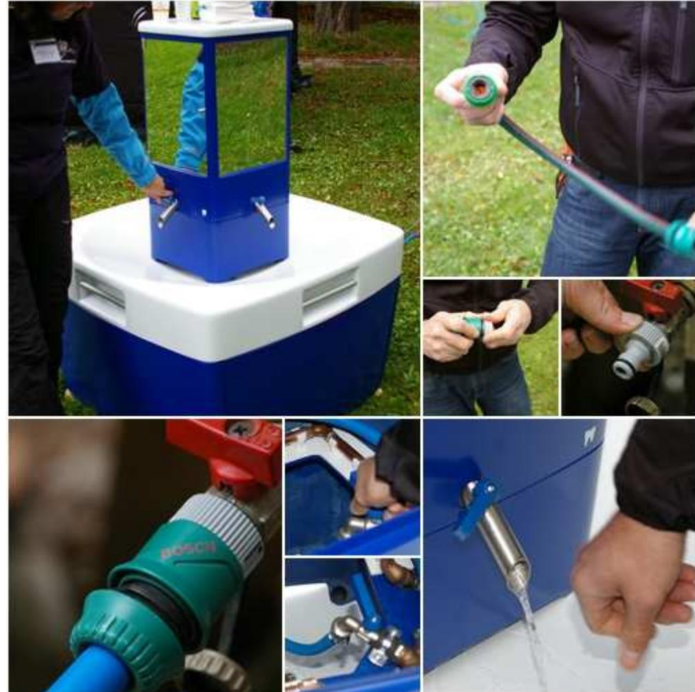
Wasseranschluss auf Dichtigkeit überprüfen, auch unterhalb des Beckens.
