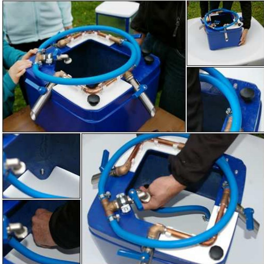
Säulenoberteil mit Spiegeln so auf das im Becken montierte Unterteil aufstecken, dass die zwei weißen Markierungen an den Teilen (weißer Zahn, Spiegeltür) übereinander zu liegen kommen.
